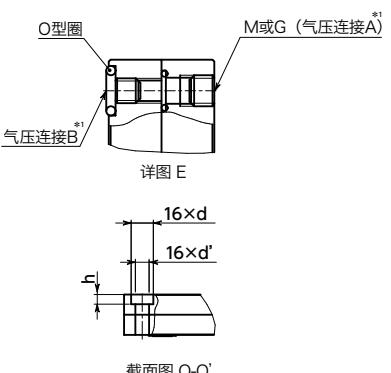
\*1: 可从任何一个气压连接供应气体。使用气压连接B时, 请使用附带的O型圈。
