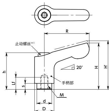
\*1：将止动螺丝的头部形状从内六角圆柱头变更为梅花槽。
