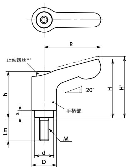
\*1: 将止动螺丝的头部形状从内六角圆柱头变更为梅花槽。
