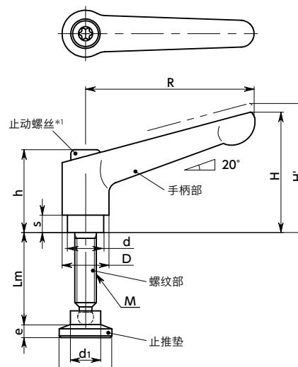
\*1：将止动螺丝的头部形状从内六角圆柱头变更为梅花槽。
