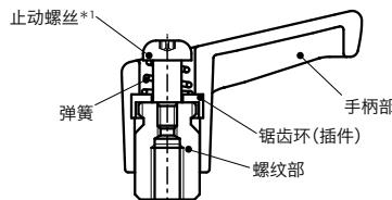
\*1：将止动螺丝的头部形状从内六角圆柱头变更为梅花槽。
