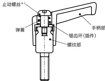
\*1：将止动螺丝的头部形状从内六角圆柱头变更为梅花槽。
