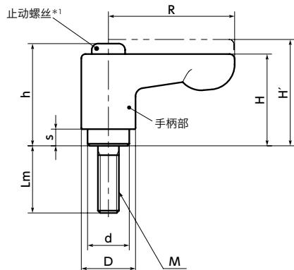
\*1：将止动螺丝的头部形状从内六角圆柱头变更为梅花槽。
