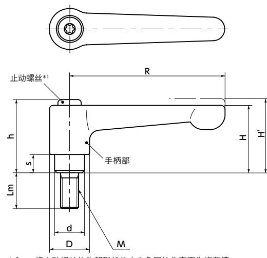
\*1：将止动螺丝的头部形状从内六角圆柱头变更为梅花槽。
