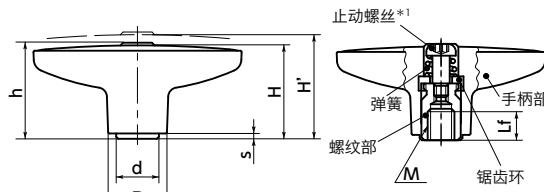
\*1：将止动螺丝的头部形状从内六角圆柱头变更为梅花槽。
