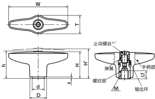
\*1: 将止动螺丝的头部形状从内六角圆柱头变更为梅花槽。
