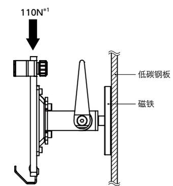
\* 1: 脱落载荷为静态载荷的试验值。在室温环境下，将磁铁完全接触厚度为10mm的低碳钢表面，然后从上方施加载荷，测量磁铁从钢板表面脱落的载荷。
