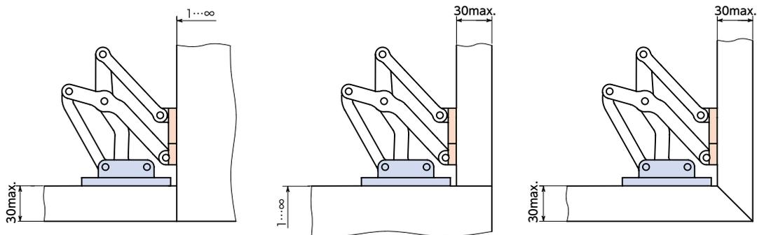
● 显示的设计方案表示在标准安装条件下。最大面板厚度取决于面板厚度及安装位置。
