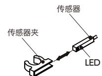
② 拧紧传感器的内六角止动螺丝, 将传感器固定在传感器夹上。
