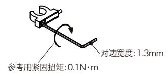
③ 请以任意方向将传感器夹嵌入分度柱塞的沟槽中, 并根据需要旋转传感器夹调整方向。
