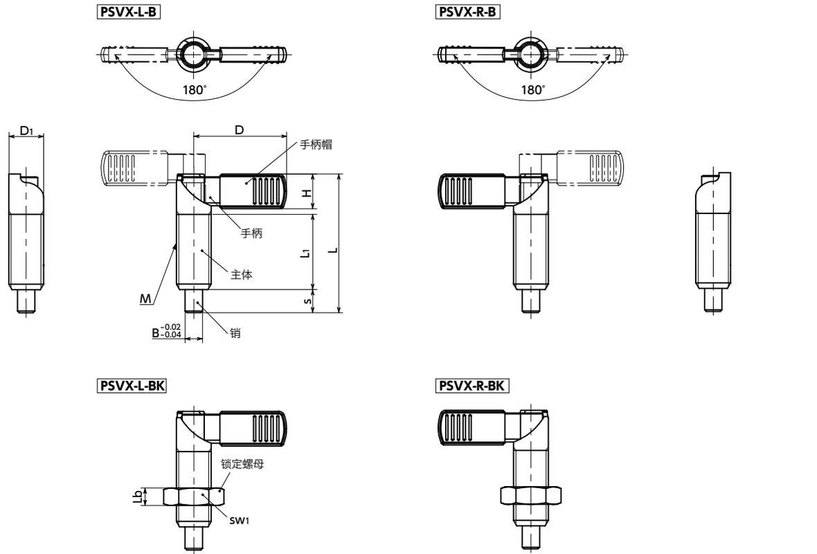
**PSVX-L-B** 向左旋转手柄时, 销内置·无锁定螺母 **PSVX-R-B** 向右旋转手柄时, 销内置·无锁定螺母 单位: mm
