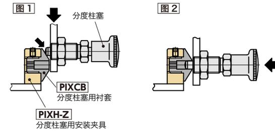
● 适用分度柱塞用安装夹具
