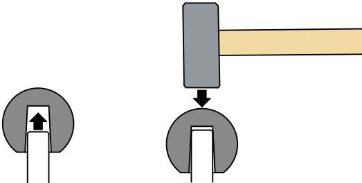
①将轴相对于旋钮的安装孔垂直插入。 ②请用塑料锤轻轻敲打旋钮进行安装。
