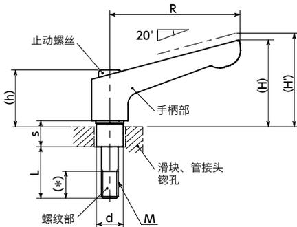
\* 螺丝部长度采用向滑块、管接头安装的专用设计。
