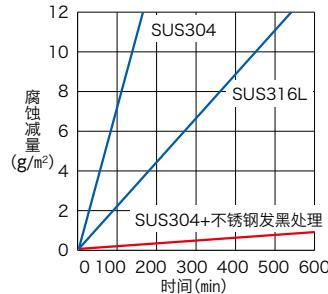
这是在单位时间内比较试样在盐酸性6%的三氯化铁溶液中的腐蚀减量的图表。
