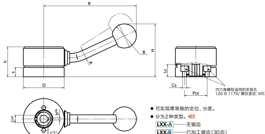
● 可实现零背隙的定位、分度。
