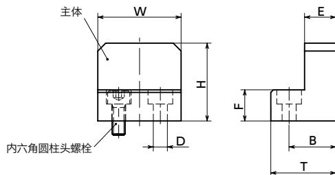
\* : 请根据安装面到平台顶部的距离确认H尺寸、并进行选择。
