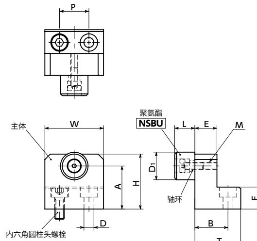
\* : 请根据安装面到平台顶部的距离确认A尺寸、并进行选择。
