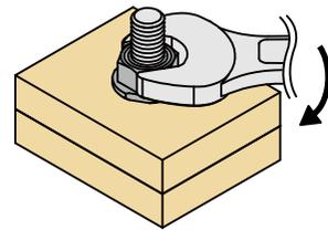
● 拆卸时需要专用工具 **SKW**。市售的工具只能拆下盖螺母。底座螺母的形状不适合拆卸扳钳、拉管台等。
