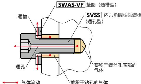
● 通槽易于排出蓄积于设备、装置的钻孔中的气体，为真空装置的真空抽吸提供支持。
